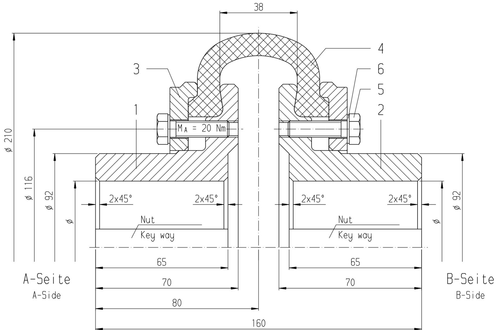
Beim Einbau der Kupplung ist die Einbau- und Betriebsanleitung zu beachten.
