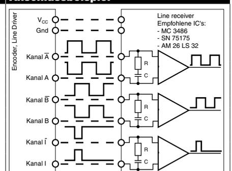
Das Indexsignal I ist synchronisiert mit Kanal A und B.
